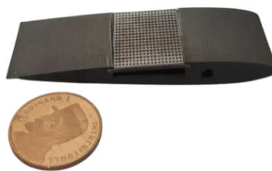
Fig. 2-5 Profil fabricat prin tăiere cu jet de apă ce conține o placă perforată de Aluminu (orificii de 0.5 mm) (sursa: Capitol 4 [29])
