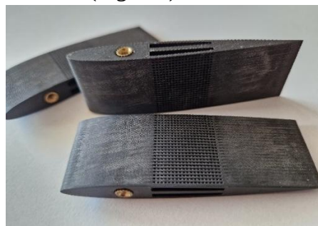
Fig. 2-9 Profil fabricat aditiv din PLA cu orificii de 0.5 mm pe placa perforată – detaliu (sursa: Capitol 5 [30])
