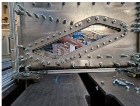
Fig. 2-23 Vedere laterală a rețelei liniare în zona de access optic (sursa: Capitol 7 [32])
