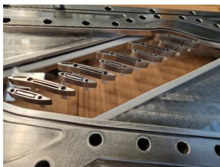
Fig. 2-20 Paletele cu control pasiv montate pe fereastra de access optic din cuarț (sursa: Capitol 7 [32])
