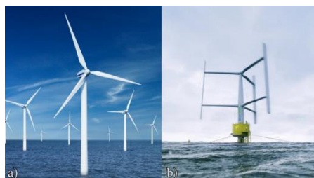
Fig. 3.2. Clasificarea turbinelor după poziția axului turbinei
