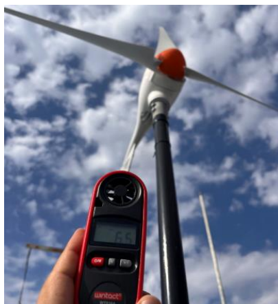
Fig. 5.2. Măsurarea vitezei vântului la nivelul turbinei eoliene cu ax orizontal
