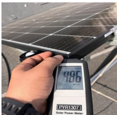
Fig. 5.6. Măsurarea radiației solare pe suprafață înclinată cu piranometrul model PYR1307
