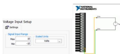
Figura 5.4 – Setările plăcuței USB 6008 în componenta virtuală DAQ Assistant
