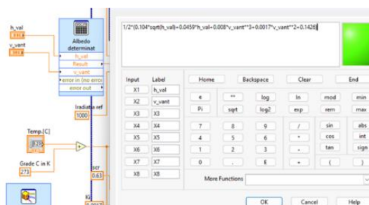
Figura 4.4 – Scrierea ecuației determinate în blocul FORMULA – LabVIEW
