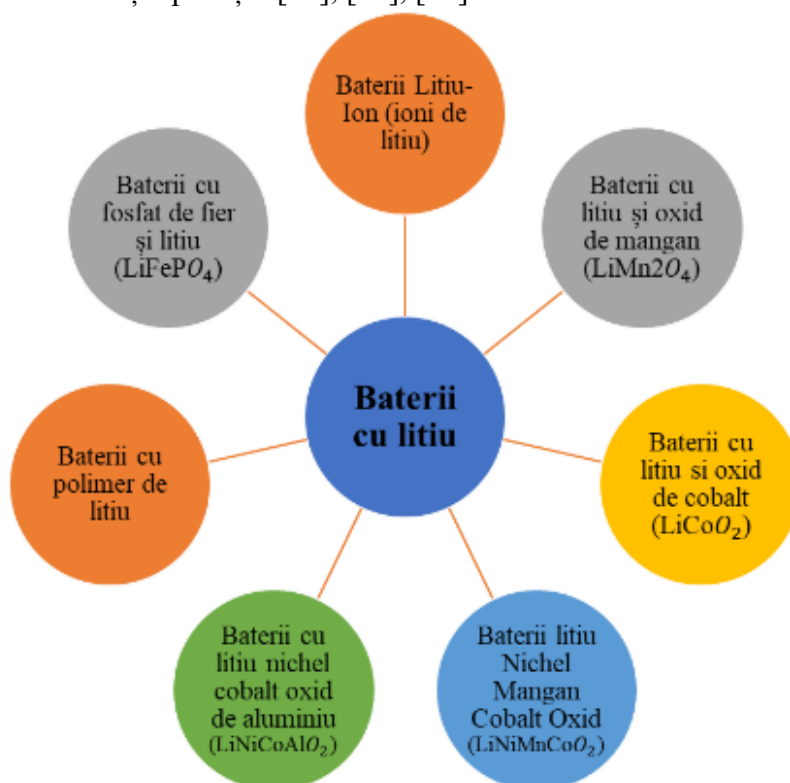
Figura 2.3 – Tipuri de baterii pe bază de litiu [27]
