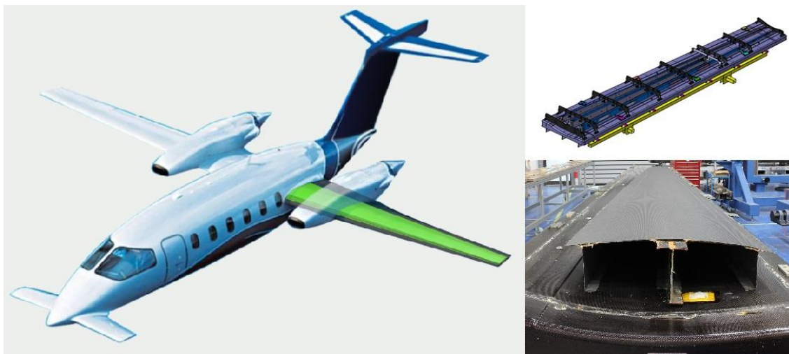
Figura 6.1. Structura aeronautica la scară reală simulată pentru predicția distorsiunii: STÂNGA - aripa aeronavei Piaggio P180, DREAPTA SUS - matrița pentru învelișul integral și lonjeroane, DREAPTA JOS - piesa de 7 metri fabricată și demultată din matriță.
