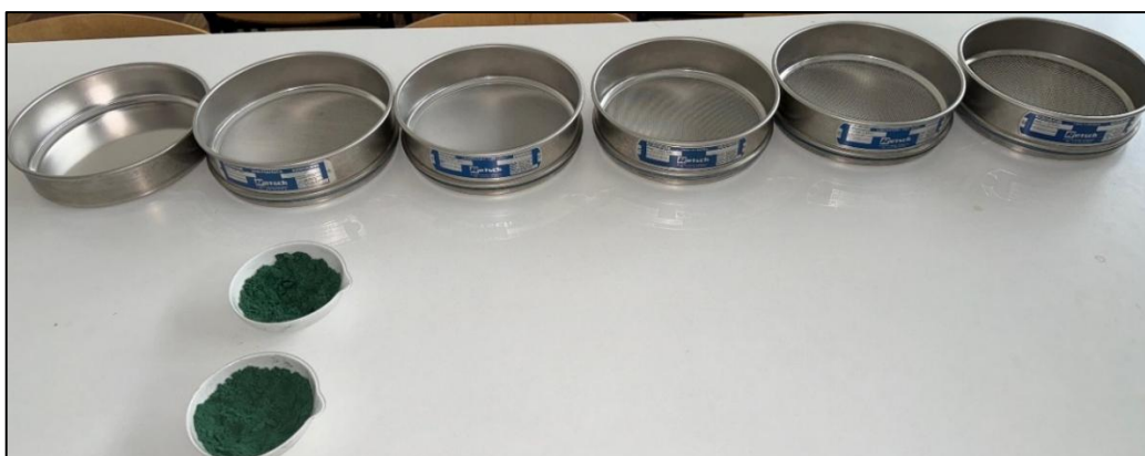
Figura 6. Separare granulometrică a materialului plastic
