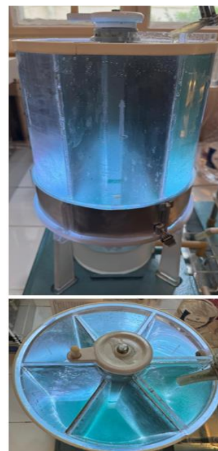
Figura 7. Instalația de decantare și filtrare microplastice Figura 8. Detaliu al decantorului multicameral al instalației de decantare și filtrare microplastice
