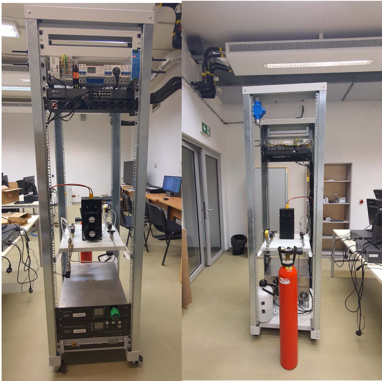
Figura 2. Demonstrator 1 – Vedere frontală și posterioară - Demonstrator de producere, stocare și consum de hidrogen.
