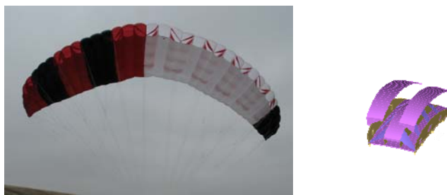
Fig. 4.3.2 Parașuta de tip aripă cu voalură tri-celulară
