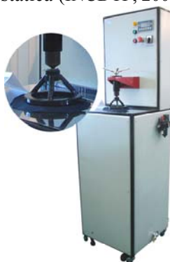
Fig. 4.3.7 Aparat destinat determinării rezistenței materialelor textile plane la penetrarea apei
