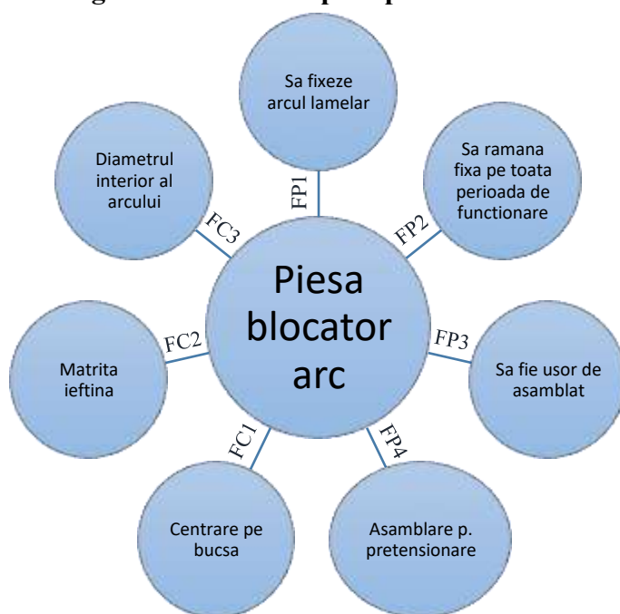
Fig. 5 Funcțiile și constrângerile piesei.
