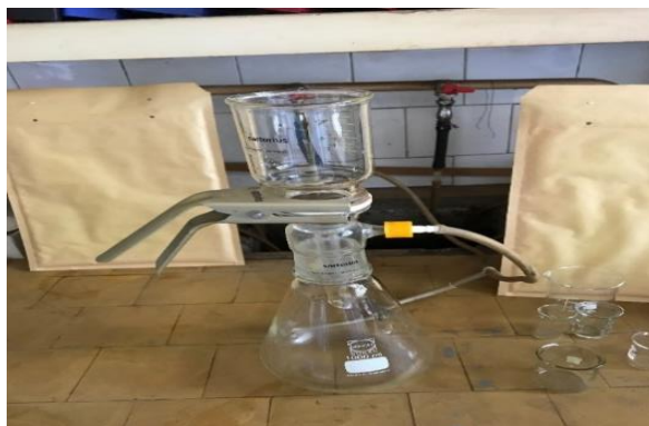
Fig. 8 Instalația experimentală de retenție a medicamentelor
