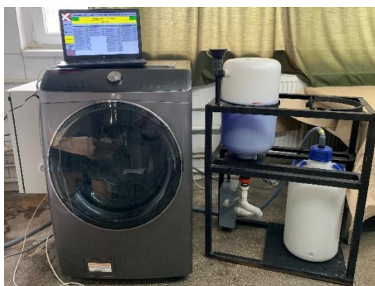
Fig. 1 Instalația de impregnare materiale textile
