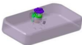
Fig. 4.6. Ansamblu rezervor – aripi închise - pre montaj
