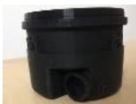
Fig. 7.5. Corp modul joja pompa
