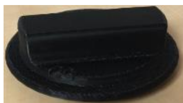
Fig. 7.10. Flanșă superioara modul joja pompă – vedere de ansamblu
