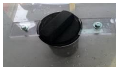
Fig. 7.18. Detaliu prindere flanșă superioara modul joja pompa prin intermediul celor doua bride
