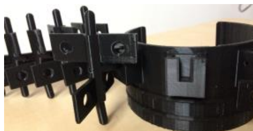
Fig. 7.15. Cilindru adiacent si fixarea structurilor tip fishbone pe acesta
