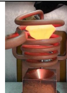
Aliajul aflat in stare topita in interiorul inductorului instalatiei.
