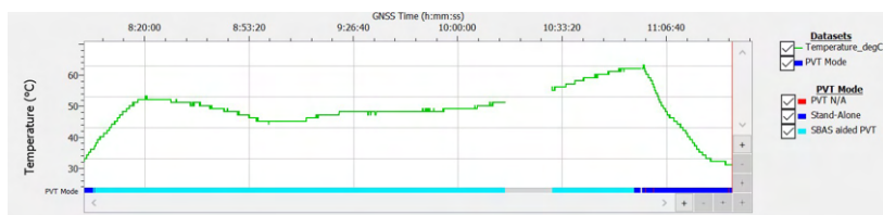
Figure 7.12: Profilul de temperatură indicat de senzorul intern al receptorului GNSS
