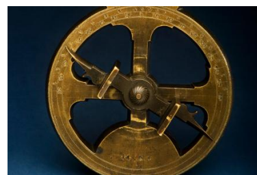
Figure 2.1: Astrolabul măsoară elevația Soarelui sau a unei alte stele față de o linie orizontală de referință (source: https://timeandnavigation.si.edu )
