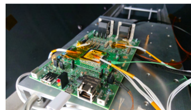
Figure 7.1: Configurarea testului de TVAC pentru receptorul GNSS
