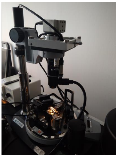
Fig. 32. Determinarea nanorugozității protezelor dentare pe microscop de tip AFM
