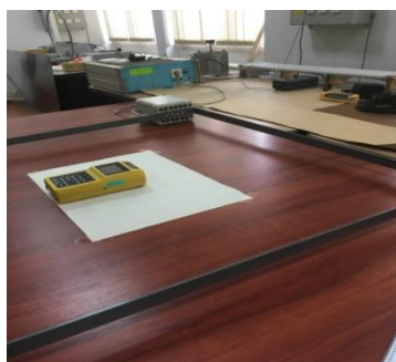
Figura 2.21. Poziționarea dispozitivului EFA-300 calibrat (stânga) și a dispozitivului Extech (dreapta) pentru măsurători comparative
