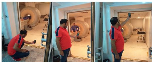
Figura 4.4. Măsurătorile câmpului magnetic la 3 distanțe (0,3 metri, 1 m și 2 m) de podea
