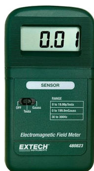
Figura 2.19. Extech 480823: Contor de camp electromagnetic cu o singură axă.
