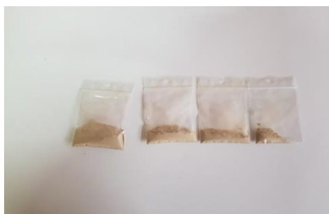
Fig.5.1 Probe de cenușă a uleiului uzat cu 20 g, 40 g, 60 g, 80 g, de bentonită
