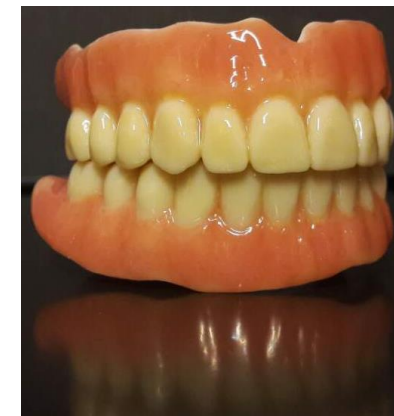
Figura 1 Proteza dentară totală printată 3D din PMMA-TiO 2
