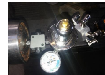
Fig. 6 Elemente pneumatice din secțiunea de comanda reactivă (RCS)
