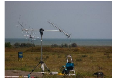
Fig. 3 Stația de sol a sistemului de telemetrie
