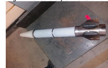
Fig. 5 Secțiunea de dirijare asamblată
