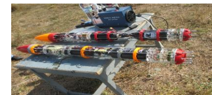
Fig. 1 Treapta a doua a lansatorului pregatita pentru incarcarea RCS la 250 bar in poligon, Sept 2019
