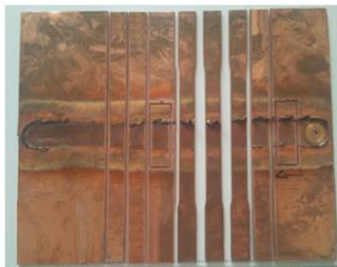
Fig. 7.1.1. Exemplificare de structură sudată și a epruvetelor prelevate din aceasta, în cadrul cercetărilor preliminare (exp. 1.1)
