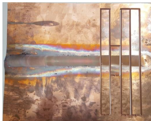
Fig. 8.1.1. Exemplificare de structură sudată și a epruvetelor prelevate din aceasta, în cadrul cercetărilor avansate (exp. 2.10)
