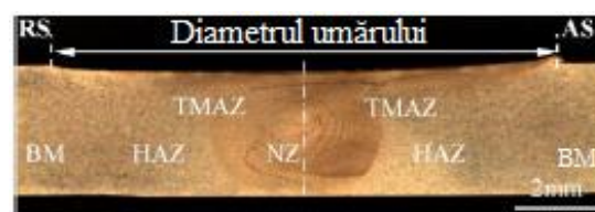
Fig. 2.3.2. Macrostructura tipică a unei îmbinări FSW a cuprului [L04]
