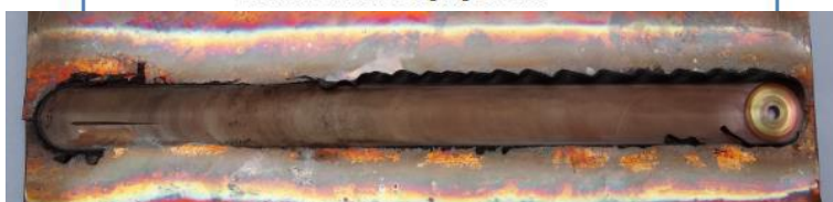
Fig. 7.2.3. Temperatura de proces, forța axială de proces (a) și aspectul îmbinării sudate (b) la sudarea FSW - exp. 1.1 ( n = 1200 rot/min, w = 90 mm/min)
