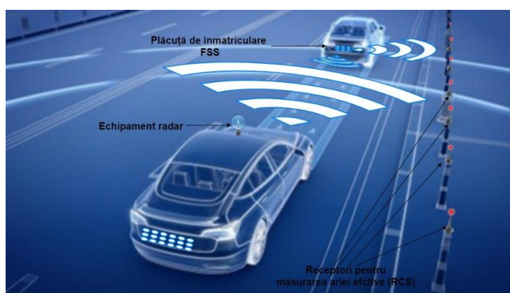
Fig. 5. 1 Principiul de urmărire și identificare al autovehiculelor dintr-o coloană utilizând plăci de înmatriculare FSS inteligente
