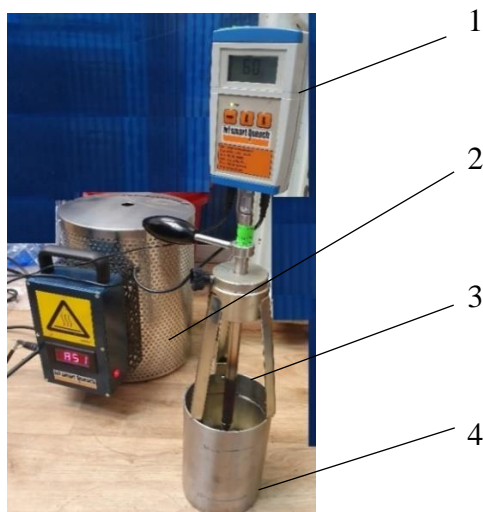
Figura 5.6. Aparatura IVF SmartQuench pentru determinarea curbei vitezei de răcire
