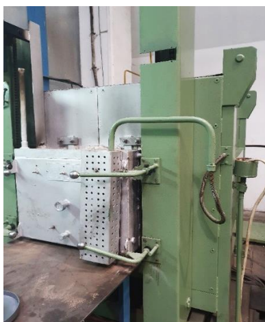
Figura 5.8. Cuptor de tratamente termice utilizat la călirea epruvetelor
