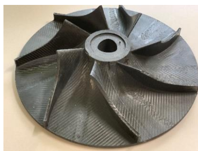
Masă rotor de referință – 13,102 Kg Masă rotor realizat din materiale compozite 2,227 Kg Figura 6.1. Analiză comparativă din punct de vedere al masei între rotorul de referință și rotorul din materiale compozite
