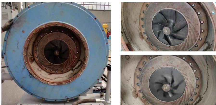
Figura 6.8. Rotor centrifugal montat în cadrul standului de experimentare
