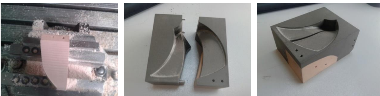
Figura 5.6. Prelucrare mecanică și asamblare matriță la scară redusă pentru realizarea unei palete
