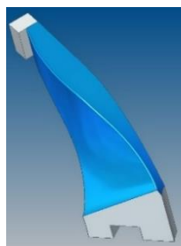
Model CAD – matriță extradados paleta
