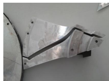
Matrițe necesare definirii unei palete de rotor
