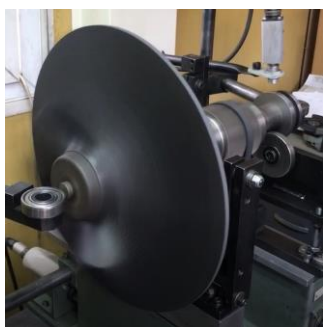
Ansamblul rotoric în timpul echilibrării dinamice
