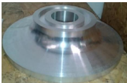
Calpodul după finalizarea prelucrărilor mecanice
