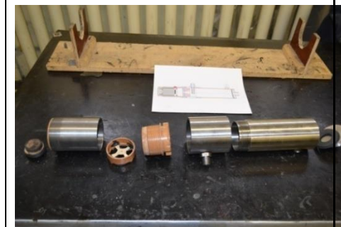
Figura 1 Motor racheta hibrid modificat (elemente componente).
