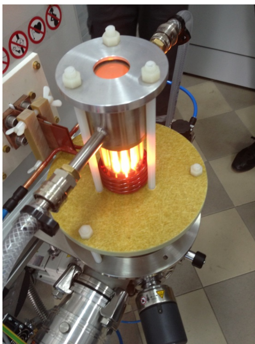
Fig. 3.3. Cuptor de elaborare cu creuzet rece, vid și atmosferă de argon
