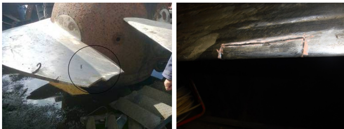
Fig. 3.2. Prelevare probe de la turbine hidroelectrice de pe raul Olt a) Izbiceni b) Frunzaru
