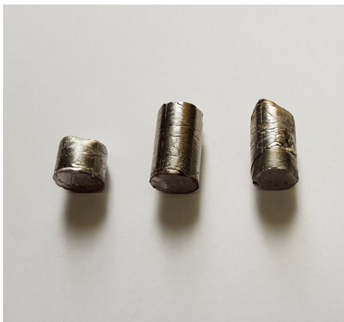
Fig. 5.1. Lingouri de oțel inoxidabil elaborate în cuptorul cu inducție cu creuzet rece
