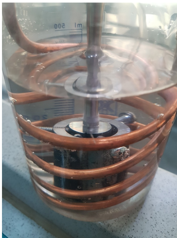
Fig. 6.1. Standul de testare a eroziunii cavitaționale, din cadrul ECOMET
