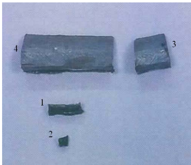
Fig. 4.6. Probe prelevate din paleta rotor turbină
