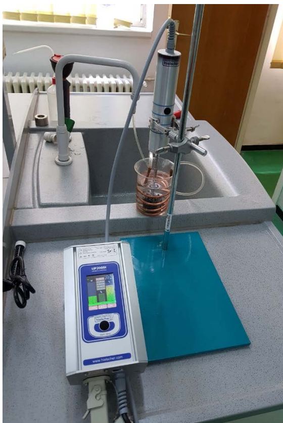
Fig. 6.1. Standul de testare a eroziunii cavitaționale, din cadrul ECOMET
