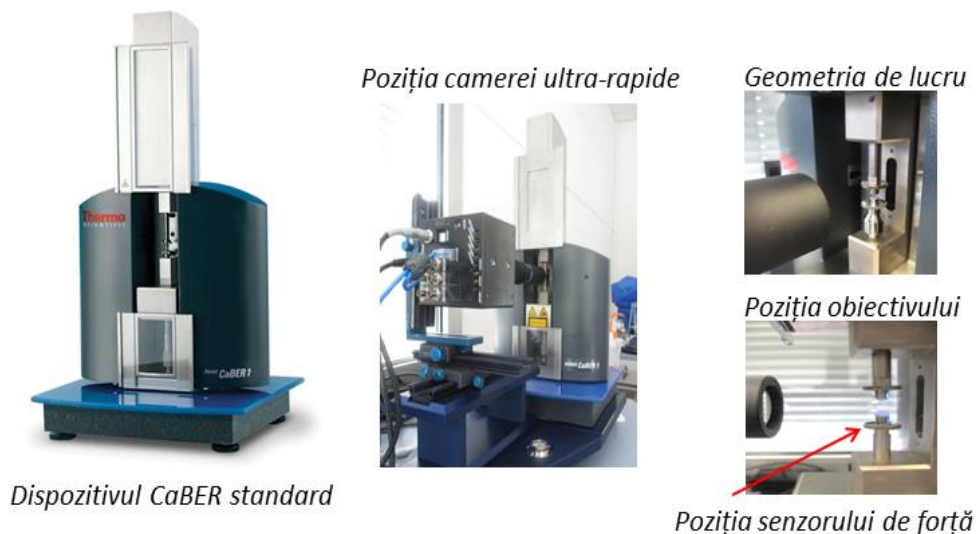
Figura 9. Dispozitivul extensional CaBER și montajul experimental utilizat.
