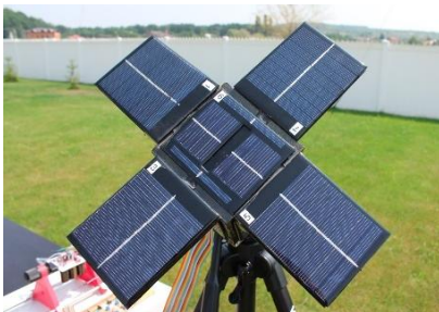
Fig. 15. Modelul fizic al nanosateliului de test cu panourile solare extinse către soare
