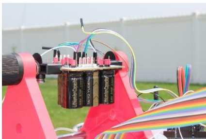
Fig. 17. Cei patru supercondensatorii integrați în SEA – imagine din lateral
