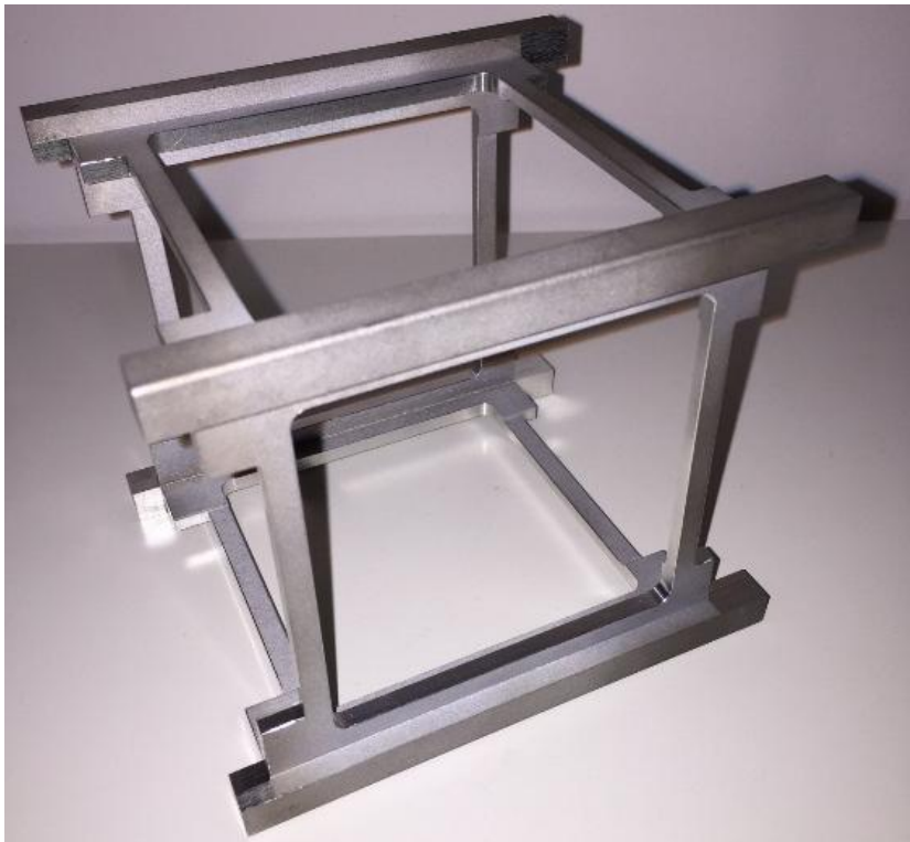
Fig. 23. Structura prototip 2 (monobloc)
