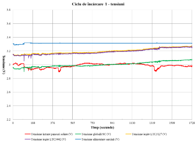
Fig. 19. Primul ciclu de încărcare – variația tensiunilor
