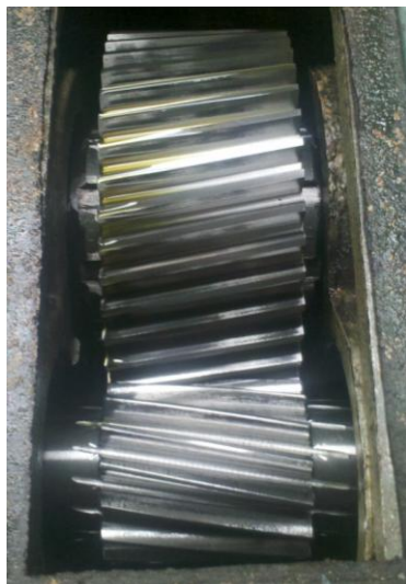
Fig. 4.11. Angrenaj cu grad de acoperire suplimentar egal cu unitatea
