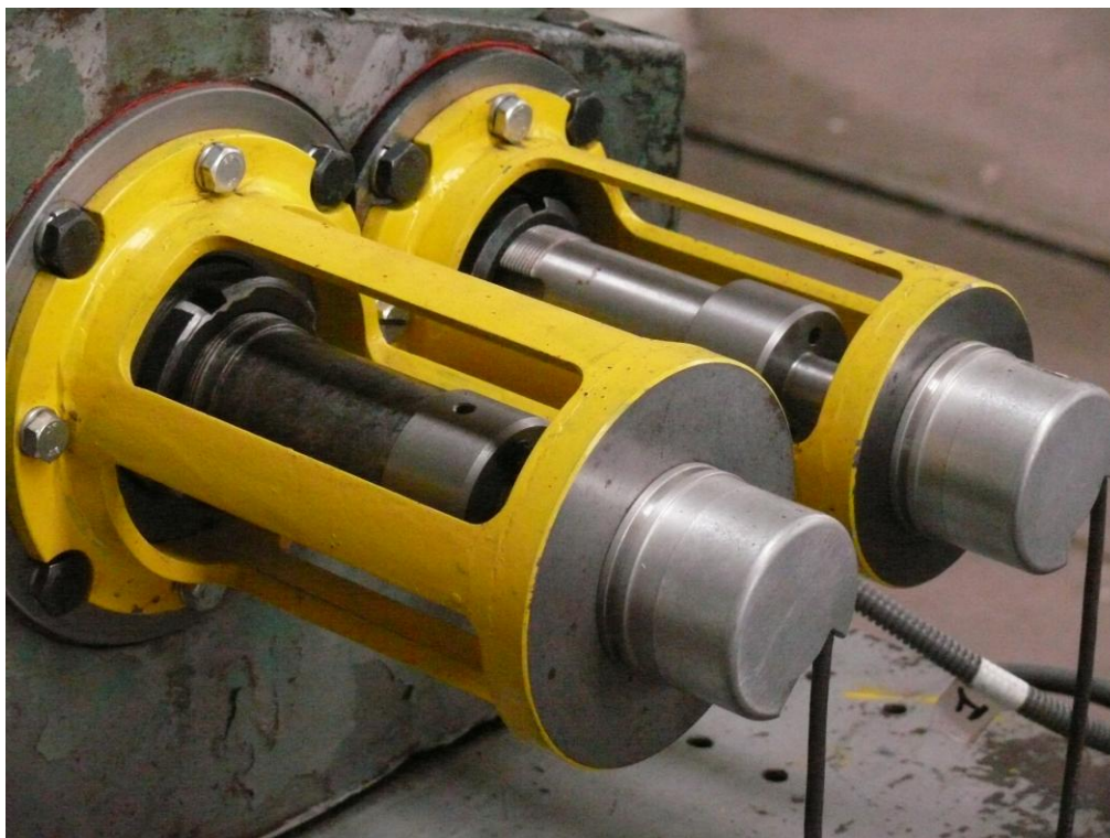
Figura4.6. Detaliu montaj traductori optici Heidenhain ROC 425
