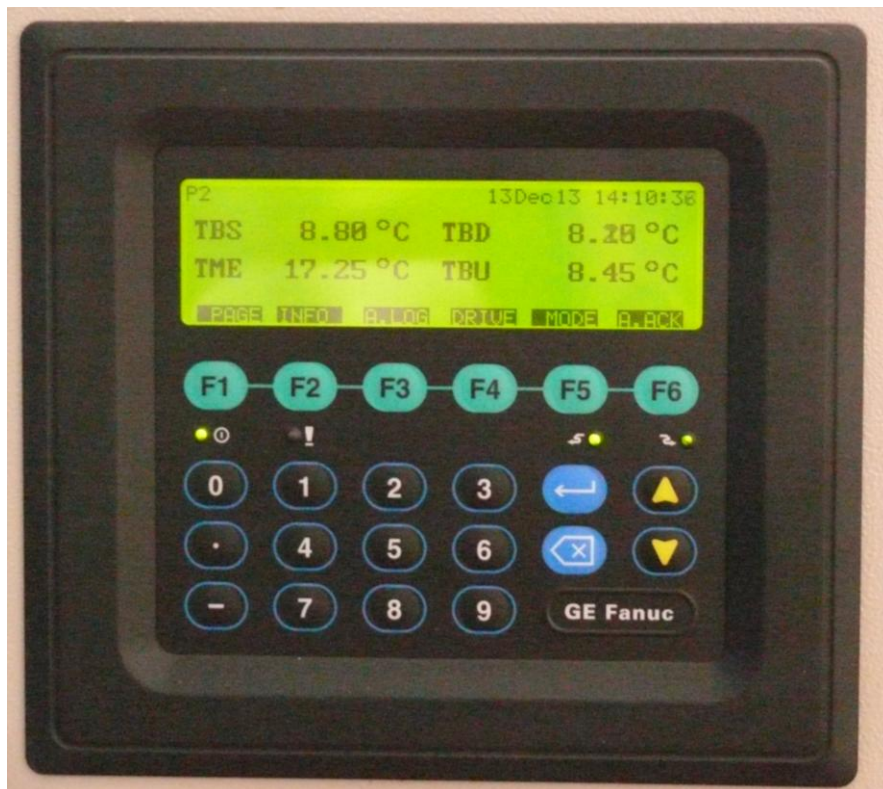
Figura 4.7. PLC control temperatura, vibrații și turație
