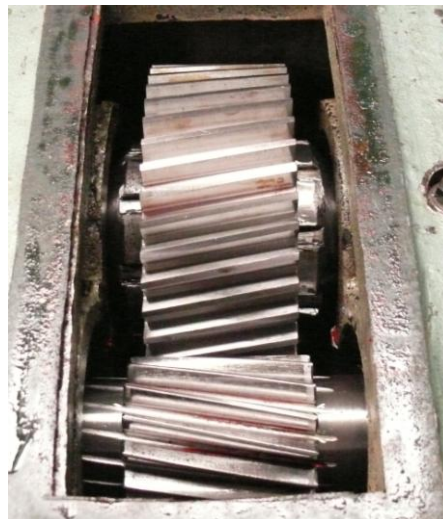
Fig. 4.12. Angrenaj cu grad de acoperire suplimentar redus
