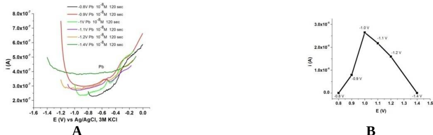
Fig. 11.2. Curbe DPV anodice de stripping înregistrate pe electrozi modificați cu poliL2352 cu diferite potențiale de reducere cu un timp de reducere de 120 s după imersarea în tampon acetat 0,1 M pH = 5,5 (acumulare timp de 10 min) la concentrația de 10^{-8} M Pb(II) (A); reprezentarea grafică a curenților de stripping în funcție de potențialul de reducere (B)
