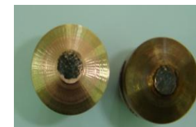
Depunere de carburi de W prin pulverizare cu laser, Microscopie optica.
