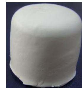
Obiect din material bioplastic pe baza de amidon, prelucrat prin termoformare
