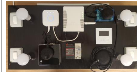
Figura 3. Demonstrator portabil de cameră inteligentă (termostat KNX, lumini inteligente Philips Hue, sistem de procesare Intel NUC, router rețea WiFi microtik, microfon Samson UB1, boxe Gembird)
