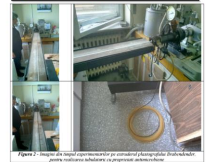
Figura 2 - Imagini din timpul experimentelor pe extrudorul plastografului Brabender, pentru realizarea tubulaturii cu proprietati antimicrobiene
