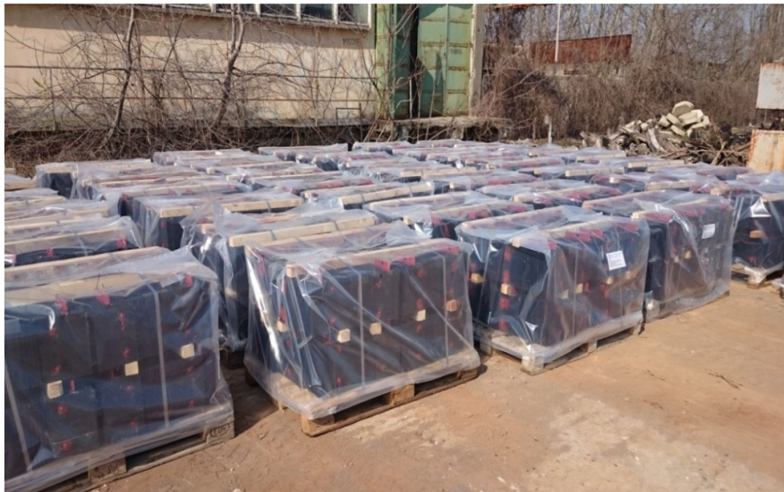
Fig. 5.1.a- Umplutura metalică nouă pentru preîncălzitorul de aer rotativ de la CET Ișalnița, formată din faguri de tabla ondulată- privire de ansamblu
