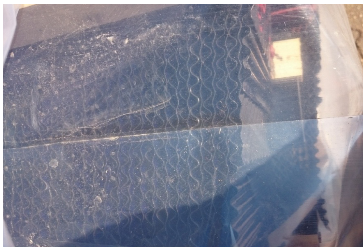
Fig. 5.1.b- Umplutură metalică din tablă emailată pentru zona rece a preîncălzitorului de aer rotativ studiat
